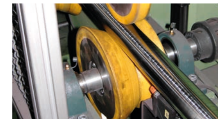
Führungs- und Druckrollen mit Wechselkern
